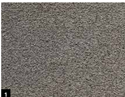
1 FOAMGLAS®, composé de petites cellules de verre hermétiquement closes.
