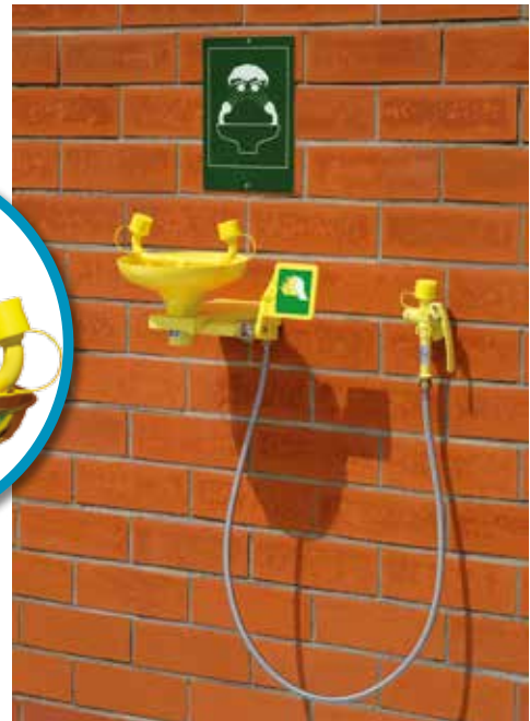
2230 LAVE-YEUX MURAL avec vasque ABS & douche flexible Inox haute pression 1m50 existe en modèle SS
