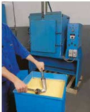
REVÊTEMENT poudre RILSAN PL11 à chaud sur pièces acier
