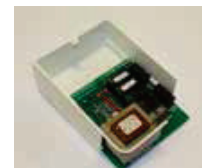
Centralisation filaire (pour 2 moteurs synchronisés) 230 VAC 600W MAX
