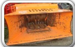
**Godet broyeur recycleur (briques, pierres, tuiles, asphalte, etc.)**
